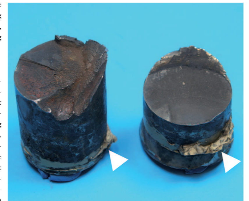
Afbeelding 1: De twee monsters voor het onderzoek aan de beschadigde rods. De pijlen wijzen naar kitresten.
