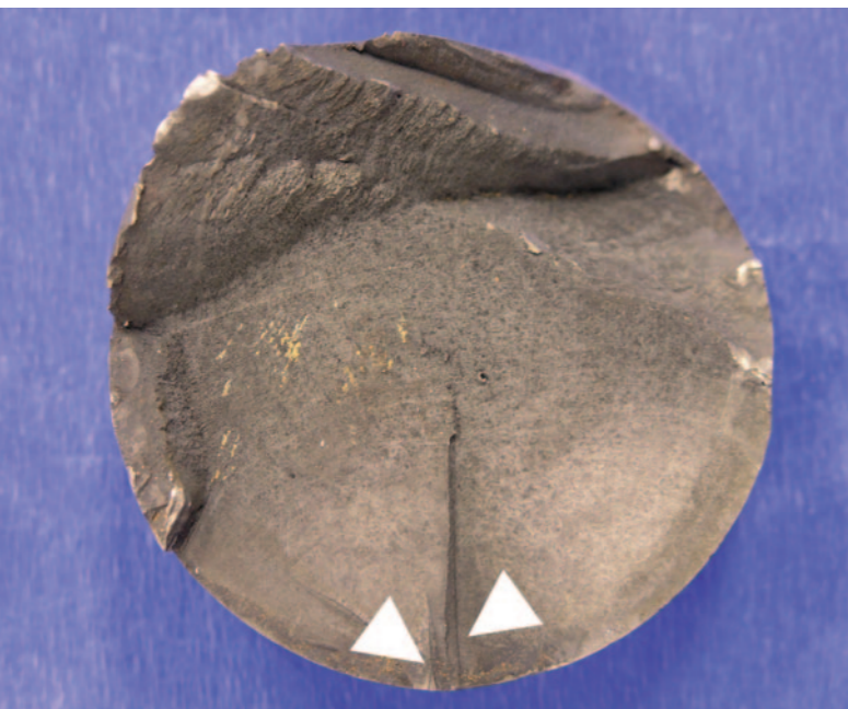
Afbeelding 2: Een van de twee breukvlakken van de onderzochte tie rods. Ter plaatse van de twee pijlen zijn vermoeiingsscheuren geïnitieerd.
