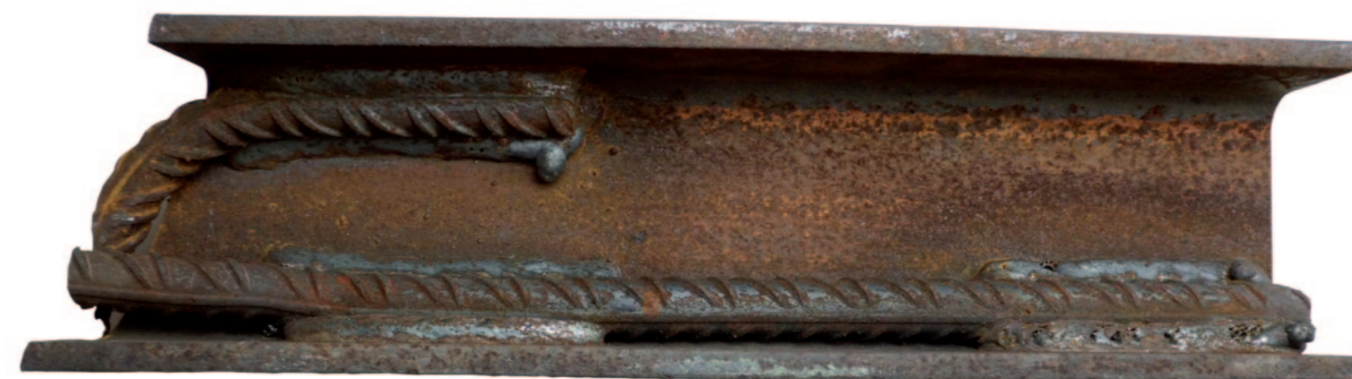
Krachtlasverbinding met veel lasfouten
