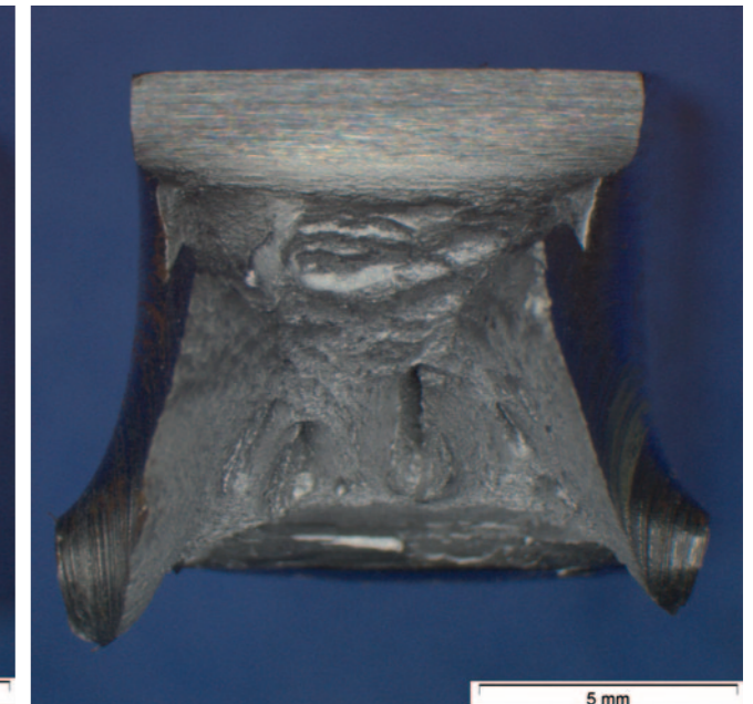
Afb. 2: Taai gebroken kerfslagstaaf met aanzienlijke vervorming.
