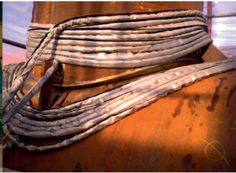
Linksboven wordt voorverwarmd met een ‘running inductor’ tijdens het OP-lassen van 30 mm plaat op 150 °C met een lassnelheid van 120cm/min
